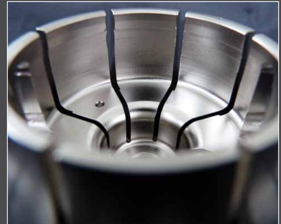
Chemisch Nickel mit mittlerer Phosphorhaltigkeit: Beschichtung nach Maß bei einem Bauteil aus dem Maschinenbaubereich.
