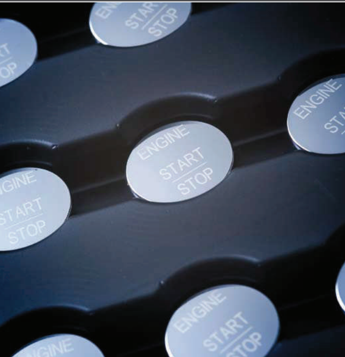
Beim fertigen Start- und Stop-Anlassknopf wurde zur Beschriftung mittels Laser die Chromschicht entfernt. Die darunter liegende Nickelschicht schützt dennoch.
