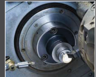
Das Polieren läuft bei Weller vollautomatisch ab.
