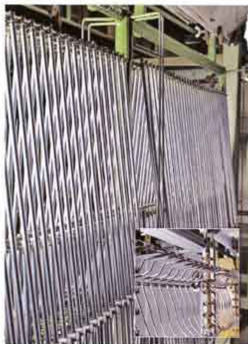
Mit FleXXKorr werden Rohrleitungen und ähnliche Produkte erst beschichtet und dann gebogen
